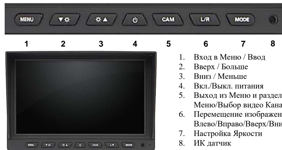
Рис. 2. Вид спереди. Кнопки управления.
