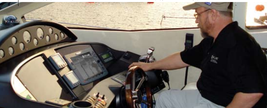
Тепловизионное изображение, получаемое при помощи FLIR System Navigator Pan/Tilt отображается на стандартном ЖК-мониторе. Joystick Control Unit - прибор управления при помощи джойстика, эстетично интегрируется в панели управления на капитанском мостике.
