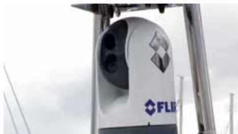
Камера FLIR M-625L на борту яхты Navetta 26 включает в себя как тепловизионную камеру, так и камеру дневного света, способную работать при низком уровне освещенности.
