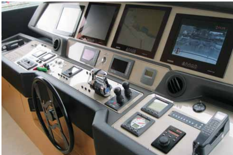
Тепловые изображения поступают на специальный экран на капитанском мостике. Модуль управления с джойстиком прекрасно вписывается в приборную панель.
