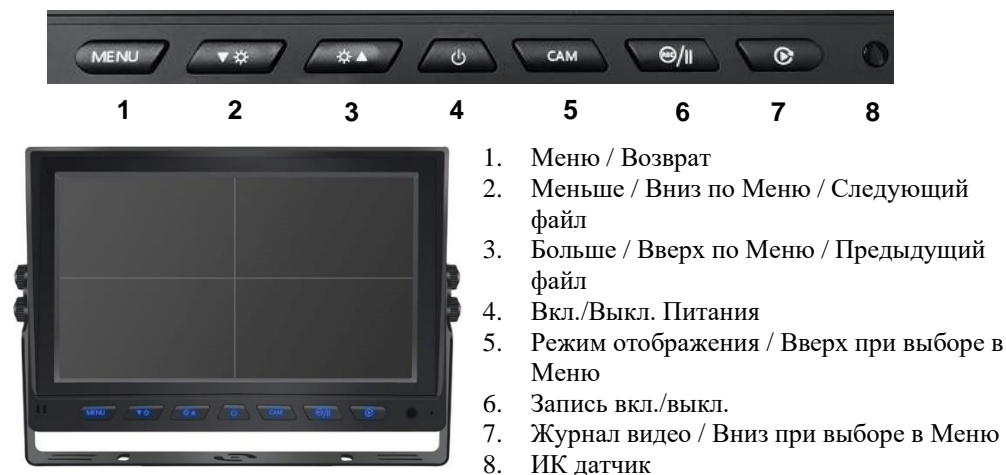
Рис. 2. Вид спереди. Органы управления монитора.
